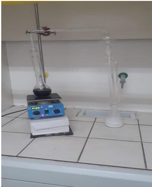
Figure 03 : Détermination de la teneur en protéines.
