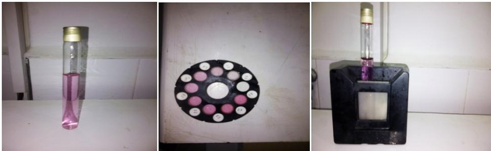
Fig 11 : le test DPD par un comparateur colorimétrique.
