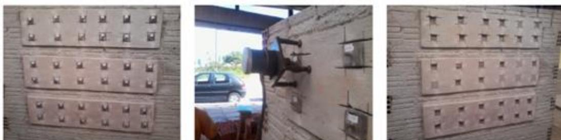
**Figure I.7:** Essai sur l'adhérence.
