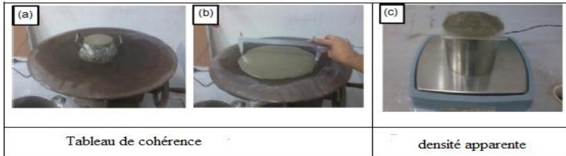
**Figure I.4:** Essai sur le mortier frais.
