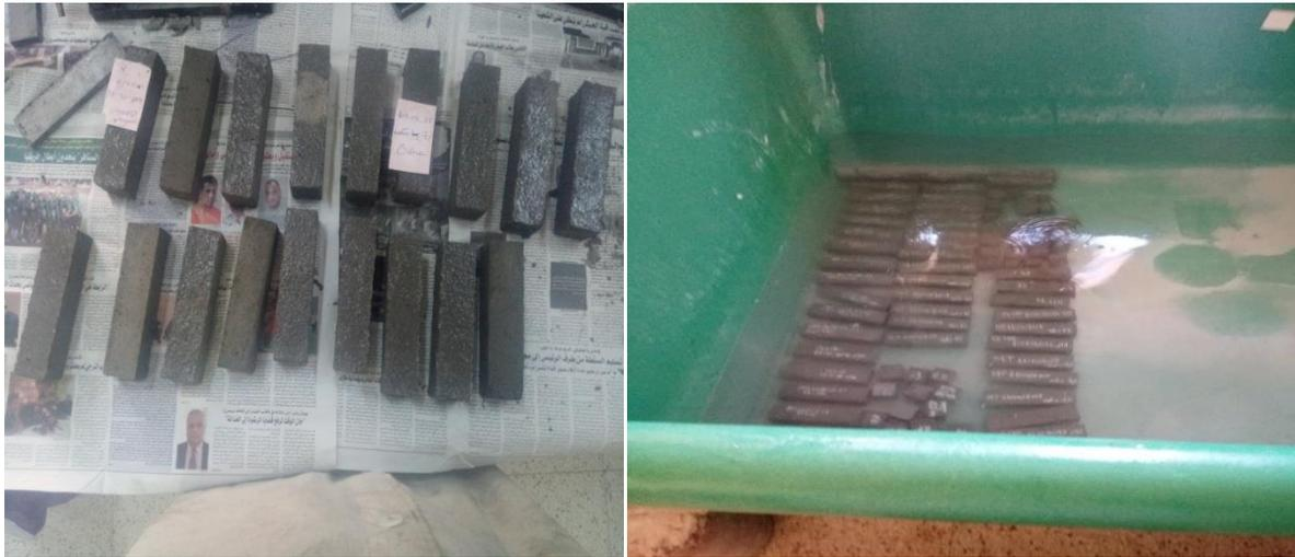
**Figure I.40:** les échantillons après démoulage conservé dans l'eau distillée.
