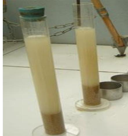
Figure I.27: Equivalent de sable.
