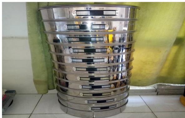
**Figure I.23: Colonne des tamis.**
