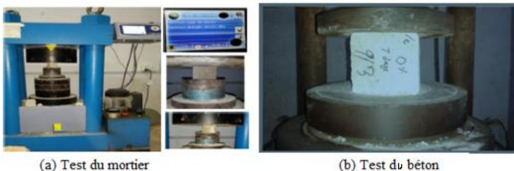
**Figure I.17:** test de résistance à la compression.
