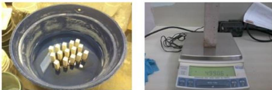
**Figure I.5:** Essai d'absorption par capillarité.
