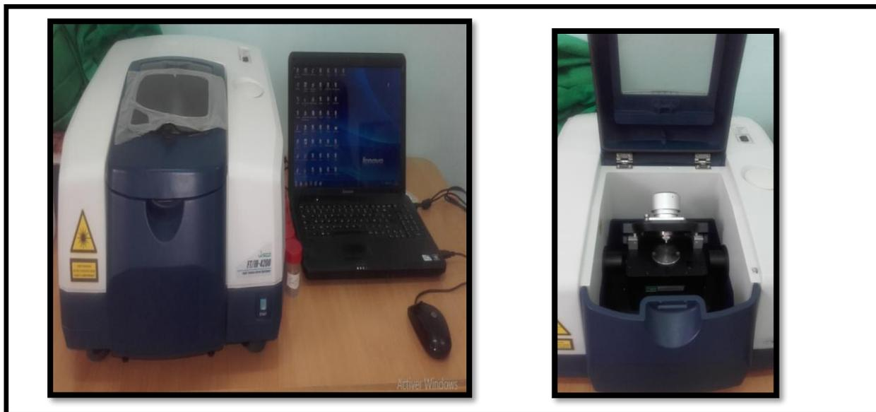
**Fig. III.8 :** Spectromètre à transformée de Fourier.
