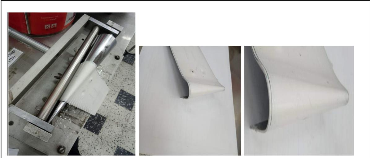
**Fig.IV.7 :** Résultat du pliage conique de la peinture de Gel Coat à base de UPR synthétisée
