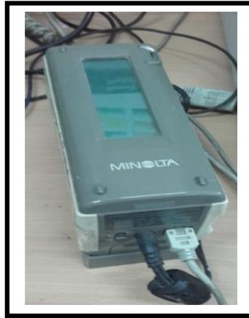
*Fig.III.10* : Spectrophotomètre CM-2500d
