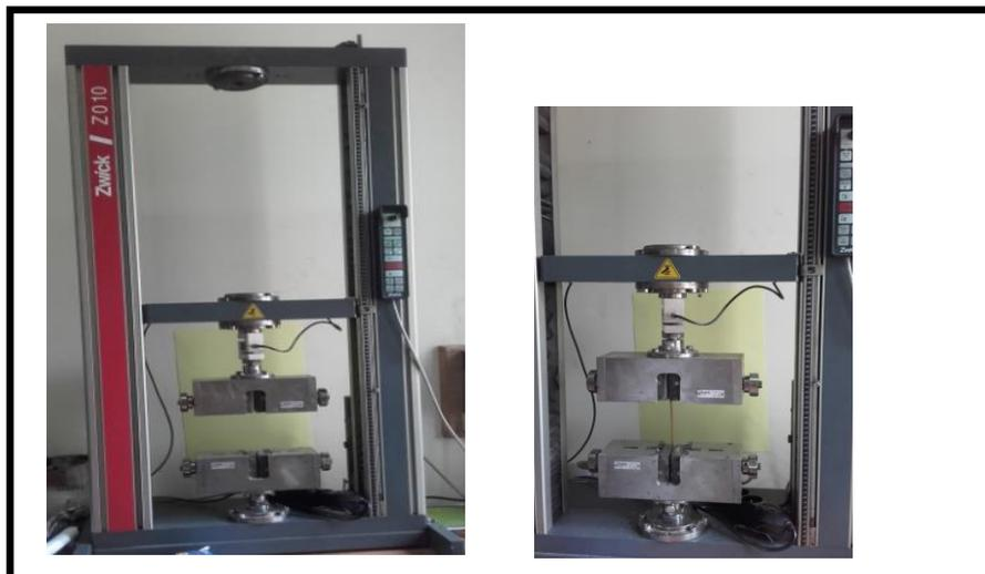
Fig.III.7 : Machine d'essais de traction électromécanique de marque Zwick / Z010
