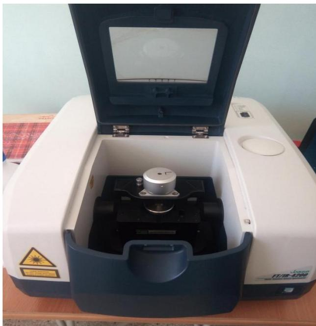
**Figure(II-9):l'appareil de FTIR.**
