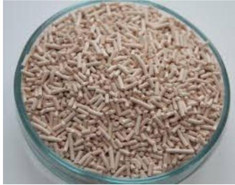
**Figure(II-4): Un exemple d'une zéolite synthétique.**
