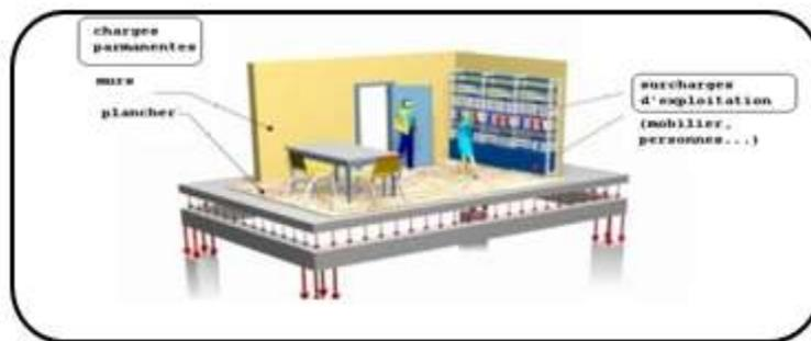
**Figure. II.9.**Distribution des charges sur les poutres.
