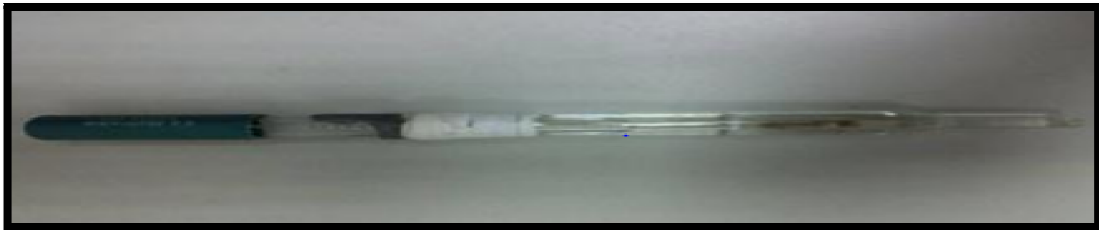
Figure III.12: Photographie de l'électrode de référence d'Argent-Chlorure d'Argent.
