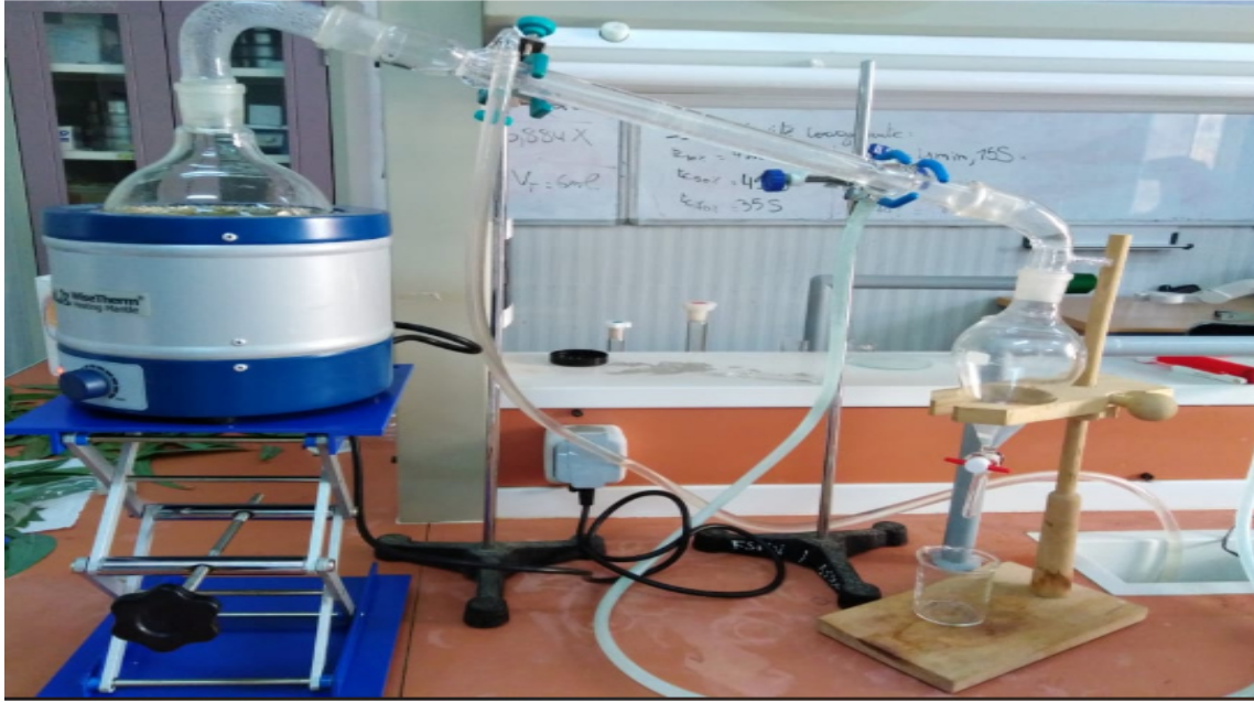
Figure 9 : Photographie du montage utilisé pour l'extraction de l'HE d' E. globulus
