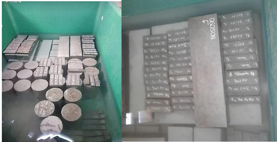
Figure IV. 16 : Conservation des éprouvettes.
