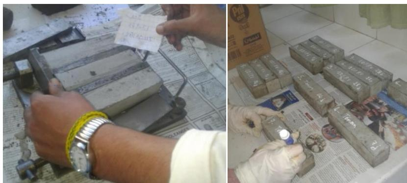
**Figure IV. 6 : Numérotation des éprouvettes après l'opération de démoulage.**
