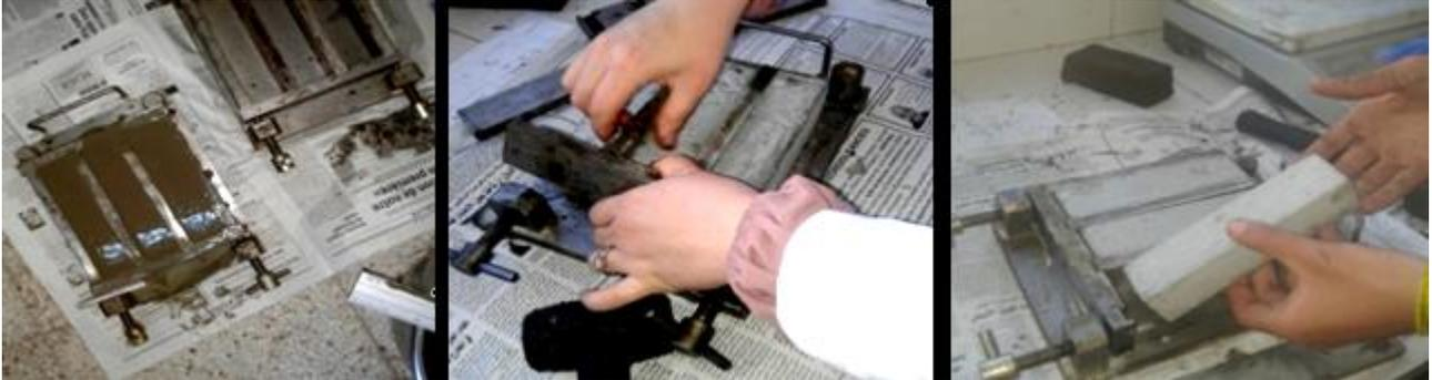
**Figure IV. 4 : Opération de moulage et de démoulage des éprouvettes.**
