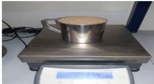
Figure IV. 10 : Essai de la masse volumique apparente des poudres.
