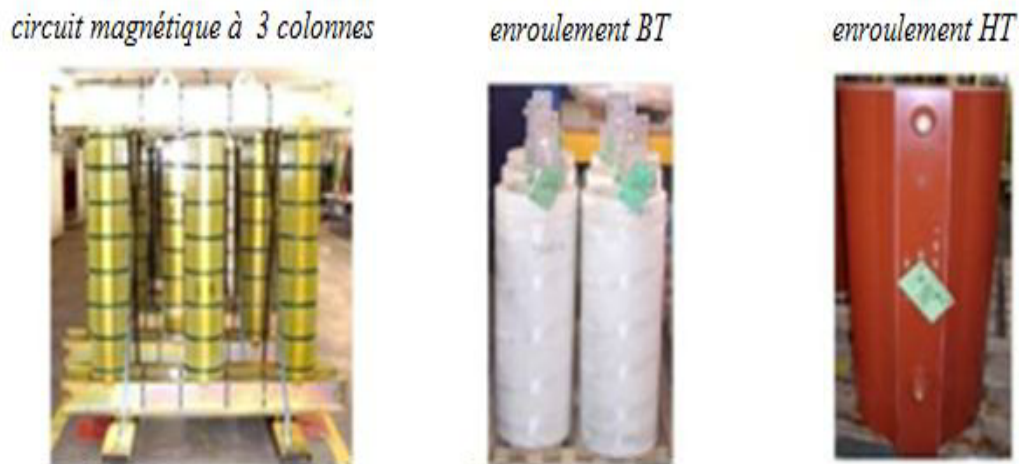
Figure I.13: Constitution d'un transformateur triphasé.
