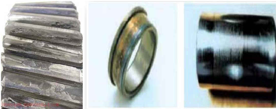
Fig. 3.3. Défauts de l'usure [19]
