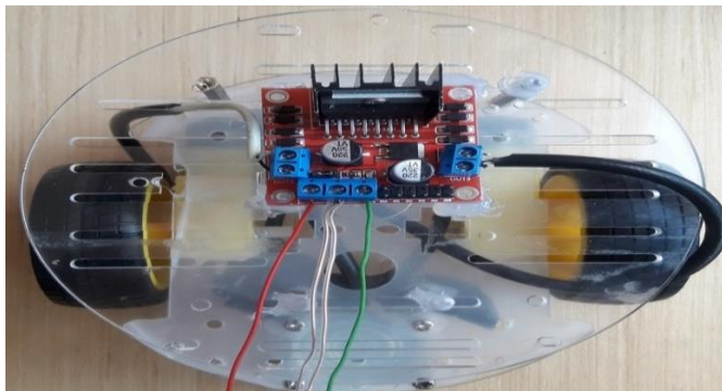
Figure 4.21 : Mise en place du L298N.
