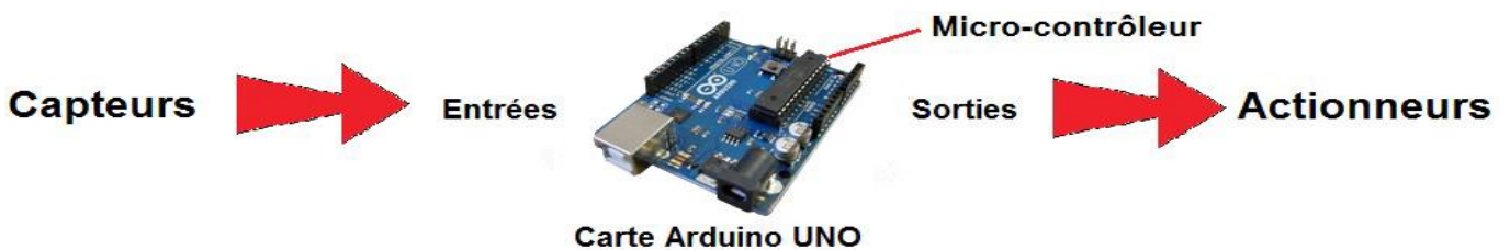
Figure 3.1 : Fonctionnement d'une carte Arduino Uno.
