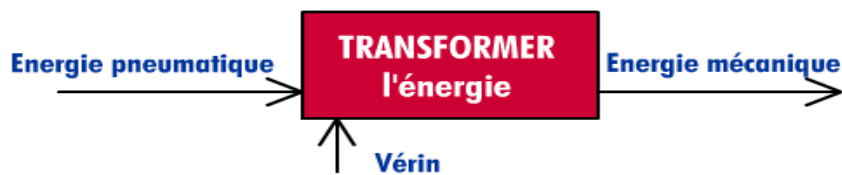
Figure II.6 : Mode de fonctionnement d'un vérin [9].
