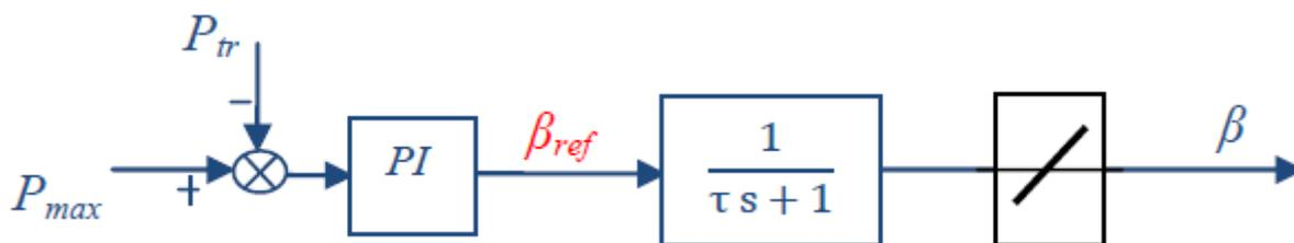
**Figure II.10.** Gestion de l'angle de calage (Pleine Charge). [24]
