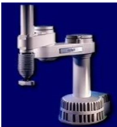
Fig.I.21. Structure d'un robot SCARA. [19]
