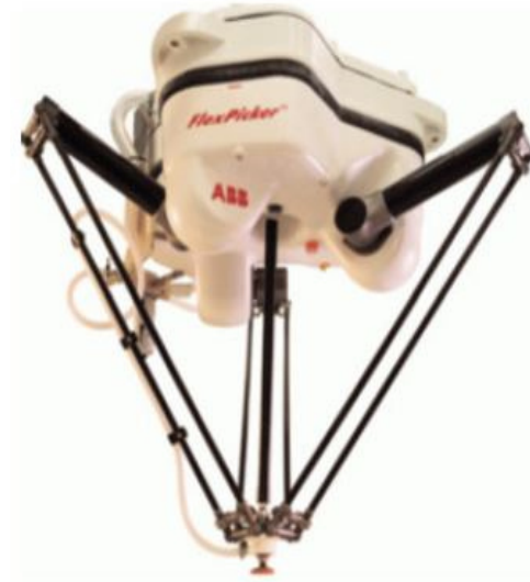
Fig.I.7. Bras manipulateur parallèle. [16]
