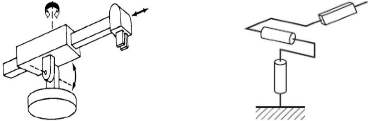
Fig.I.20. Structure d'un robot sphérique. [19]
