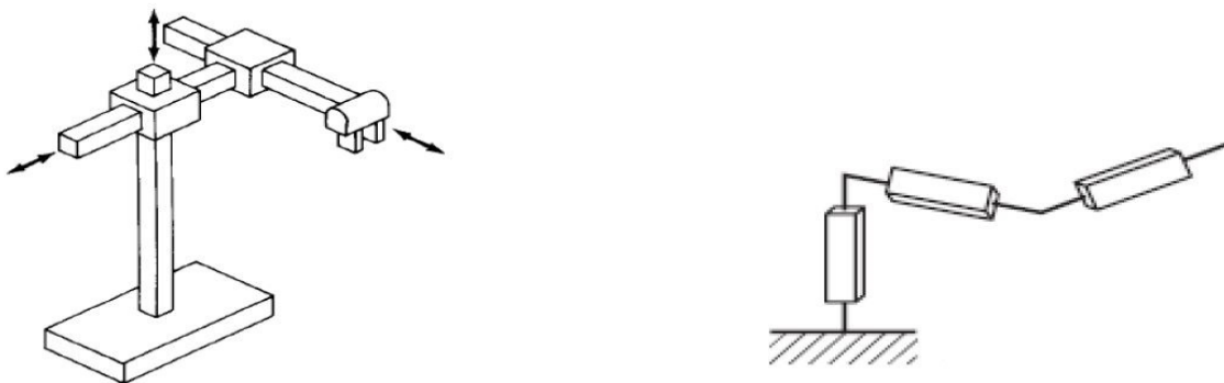
Fig. I.18. Structure d'un Robot cartésien. [19]
