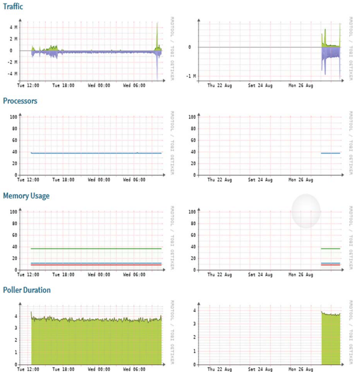
Figure IV -14: Consommation de bande passante, processeur, mémoire par machine Cisco
