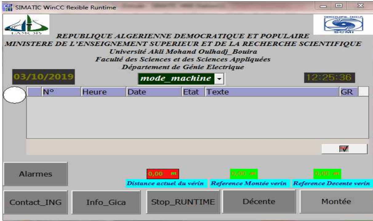
Figure IV. 12: Vue des alarmes.
