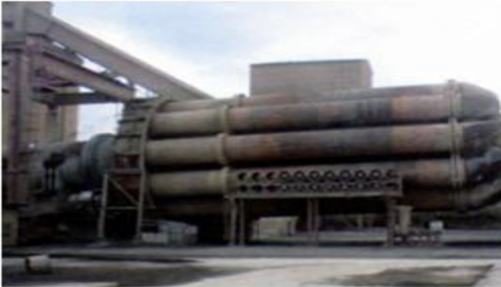
Figure I. 10: refroidisseur à grilles.
