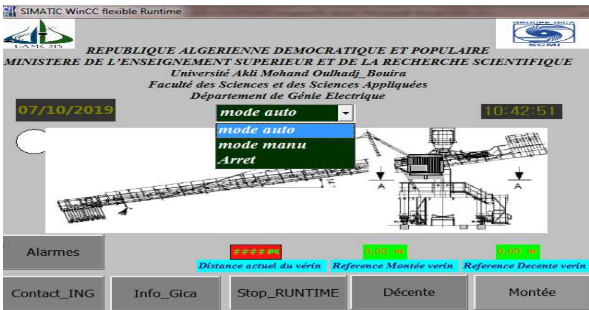
Figure IV. 9: Vue de la commande de stacker.
