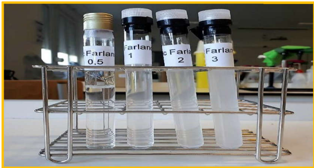
Figure 11 : Etalon de Mc Farland servent de standard de turbidité pour préparer les suspensions bactériennes (Boussena, 2020).
