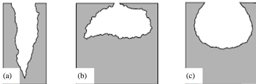
**Figure I.5 :** Formes de piqûres (a) cavité profonde (b) cavité cavernieuse (c) hémisphérique [31].
