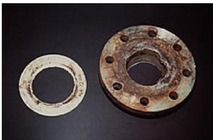
*Figure I.7 : Corrosion caverneuse d'un acier allié sous un joint [33].*
