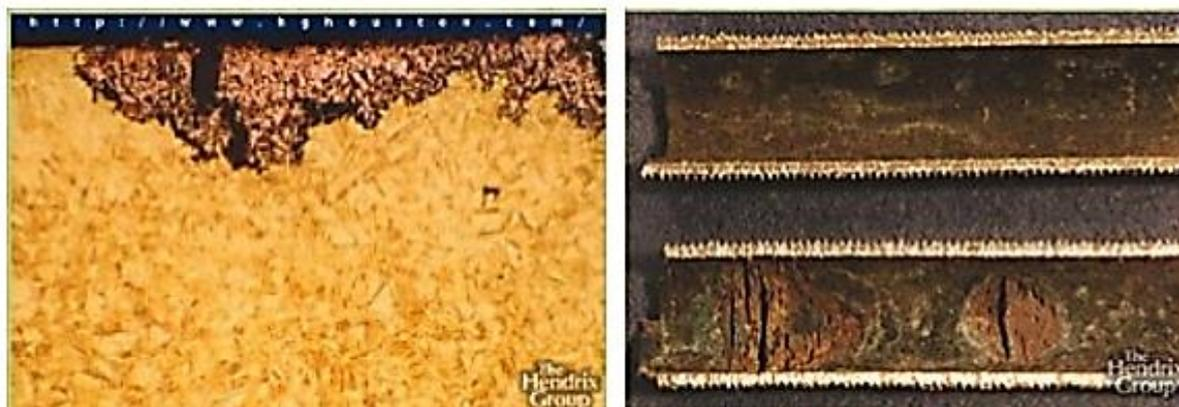
*Figure I.6 : Corrosion sélective du laiton (Cu-Zn) [32].*
