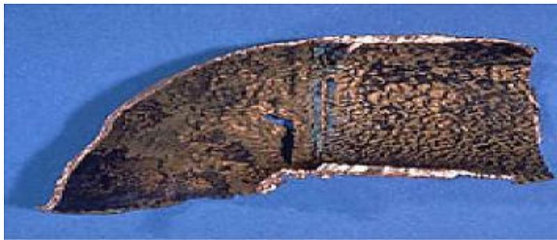
**Figure I.9 :** Étapes de développement du phénomène de corrosion-érosion [23].
