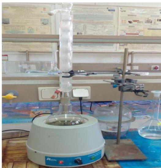
*Figure II.5 : Schéma du montage d'extraction à reflux.*
