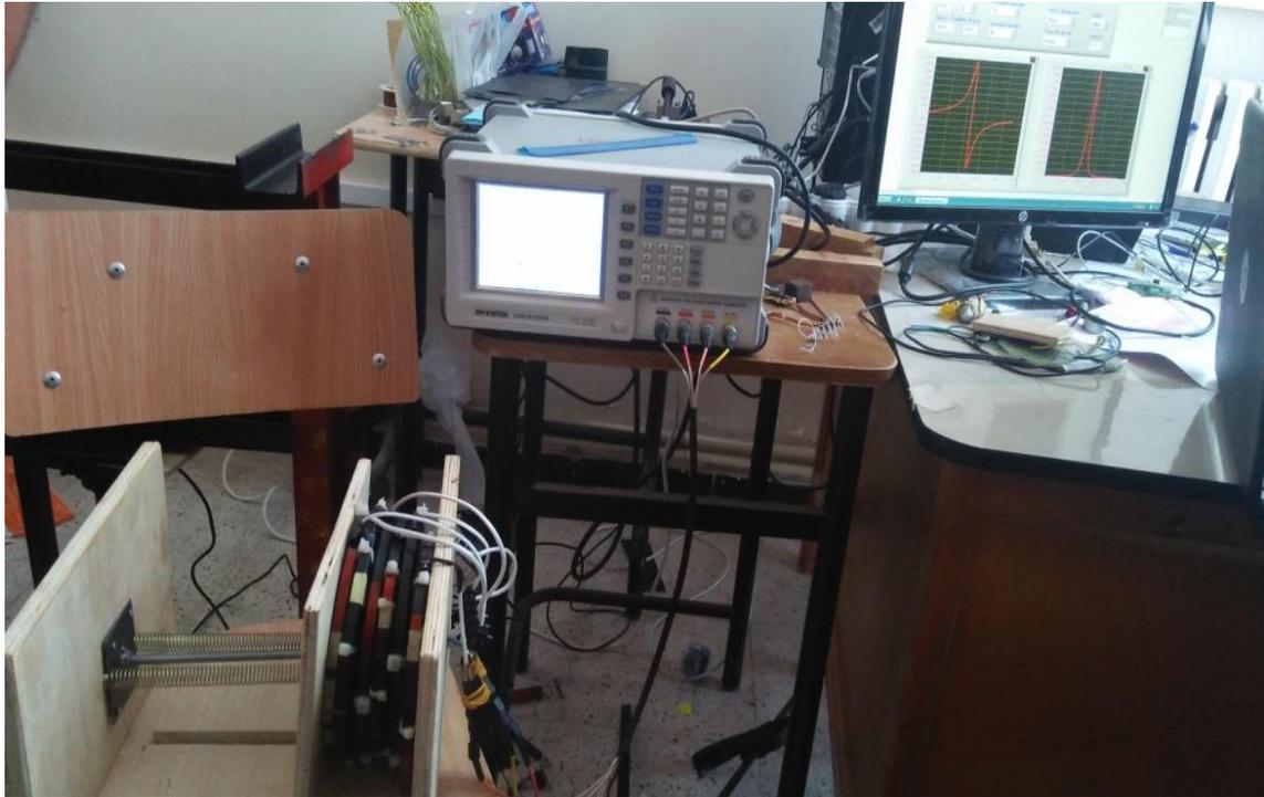
**Figure III.6:**Banc expérimental, de mesure de la réponse fréquentielle de l'enroulement.
