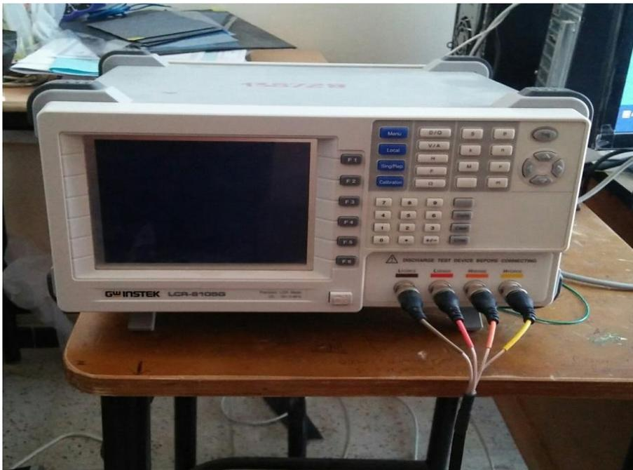
**Figure III.3:**Appareil de mesure d'impédance RLC mètre
