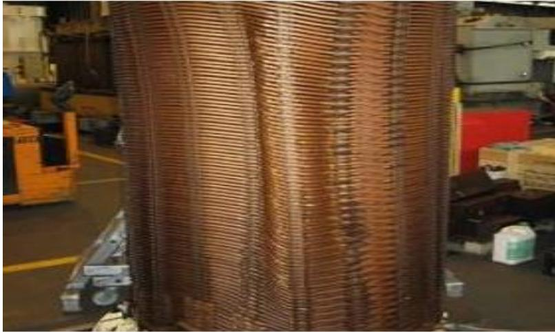
**Figure I.17:** Déformation mécanique d'un Enroulement [16].
