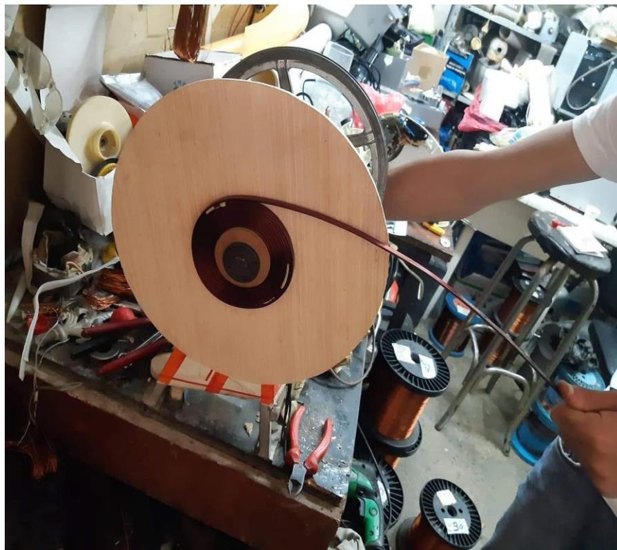
**Figure III.1:**Opération de fabrication des disques de l'enroulement.
