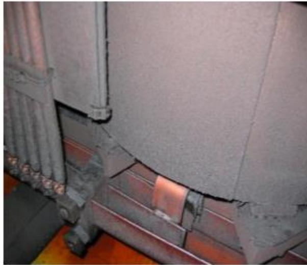
**Figure II.2:**Exemple de boue acide dans un transformateur.
