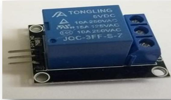
**Figure I.21 : Module relais.**
