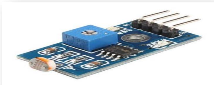
Figure I.13 : Capteur de lumière.
