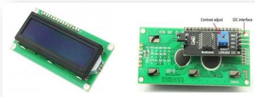
**Figure I.20: Afficheur LCD 16x2.**
