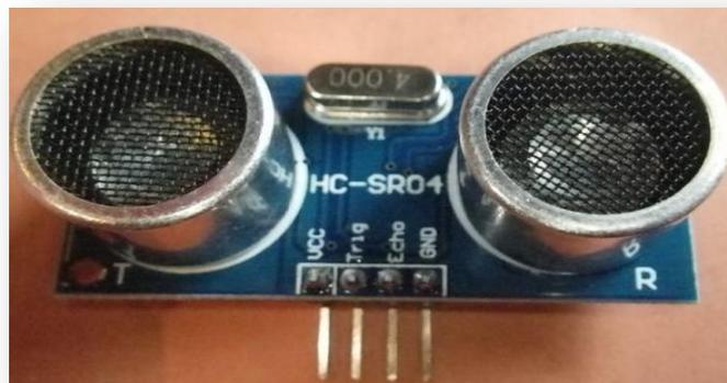
Figure I.14 : Capteur à ultrasons.
