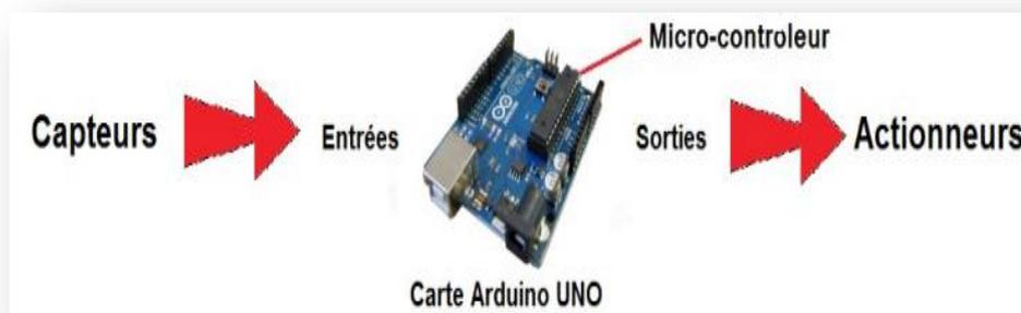
Figure I.10 : Schéma général du rôle de l'Arduino.
