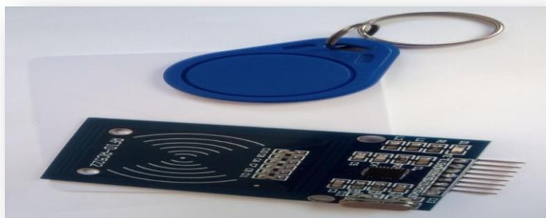
**Figure I.16 : Module RFID.**
