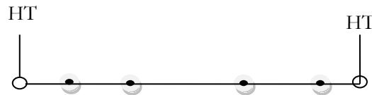
Figure 1. 2 : Exemple d'une structure d'un réseau radial.
