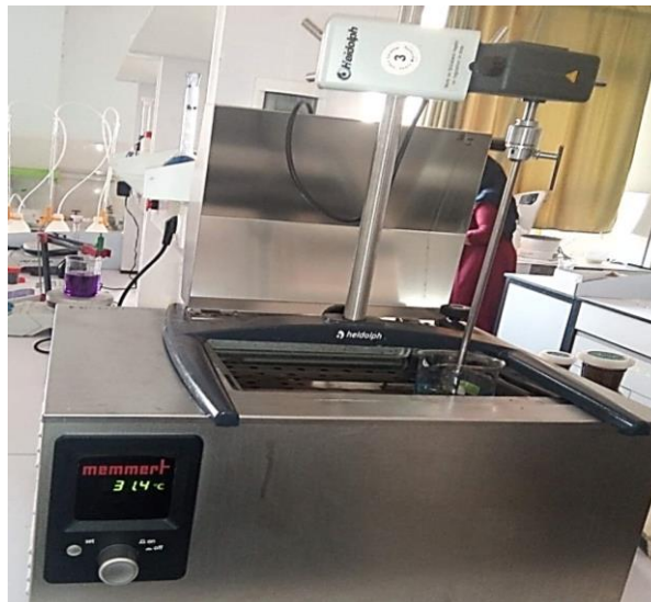
Figure II.11. Dispositif expérimental de l'étude de l'effet de la température.
