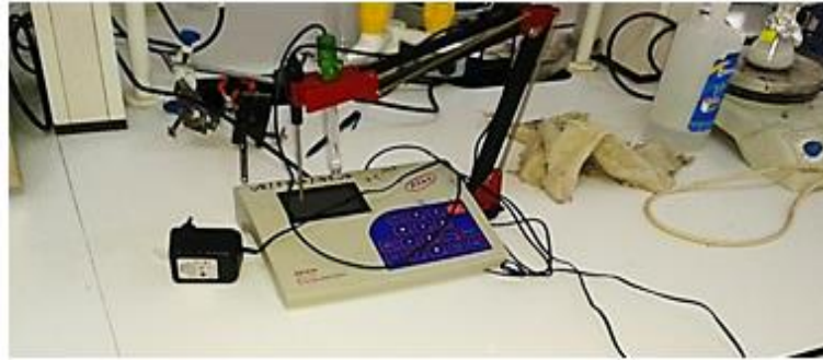
Figure II.12. Schéma de pH mètre AD1030.
