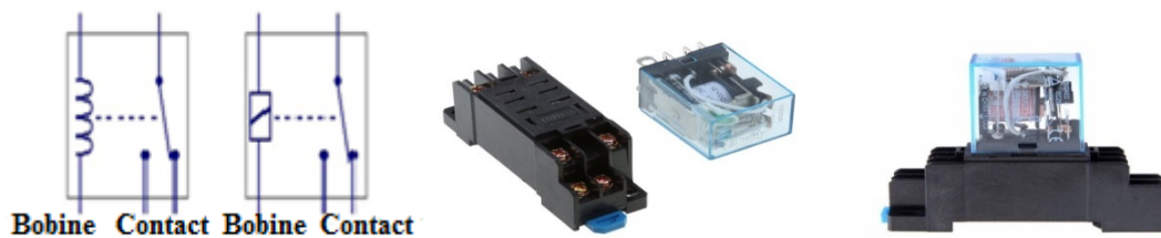
Figure II-11: Symbole et image correspondant d'un relais électronique.
