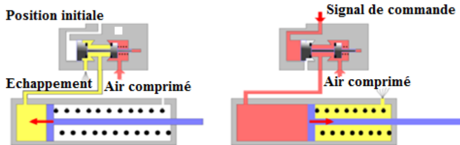
Figure II-21: Distributeur à clapets.
