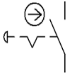
Figure II-10: Symbole et image correspondant de bouton d'arrêt d'urgence.
