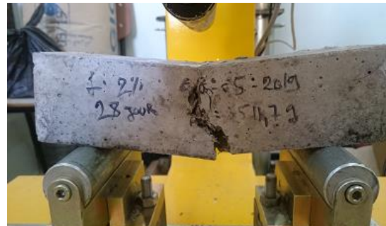
Figure V.45. Béton renforcé par les fibres métallique de SIKA.
