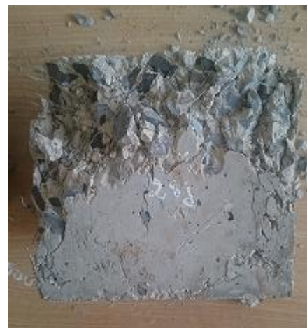
Figure V.39. Béton renforcé les fibres de SIKA
