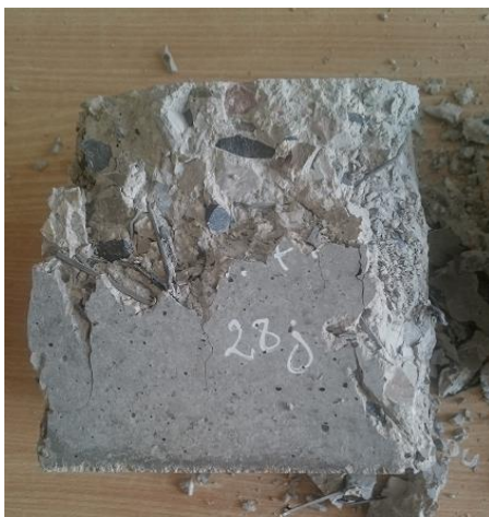
Figure V.38. Béton renforcé par les par déchets de fibres métalliques
