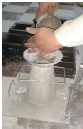
Figure IV.26. Essai d'Affaissement au cône d'Abrams.
