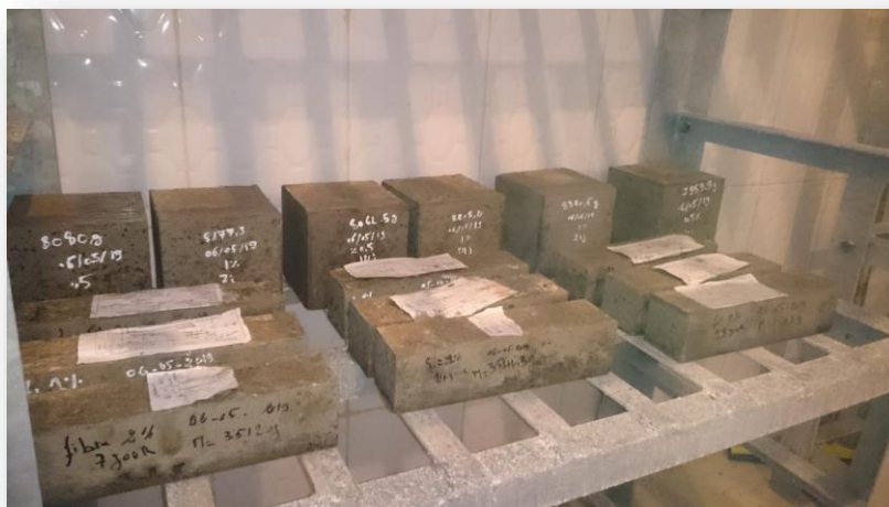
Figure IV.25. Conservation des éprouvettes dans une chambre humide.
