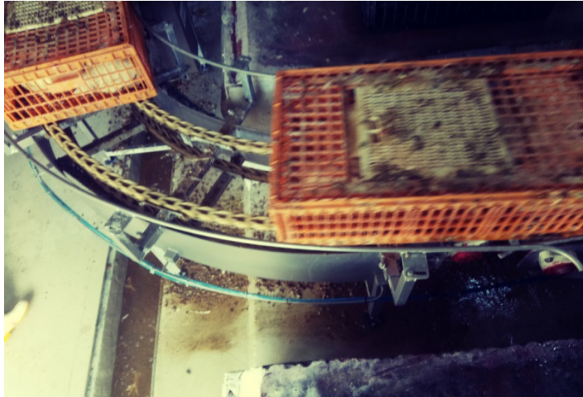
Figure 07 : déempiler les caisses (photo personnelle).
